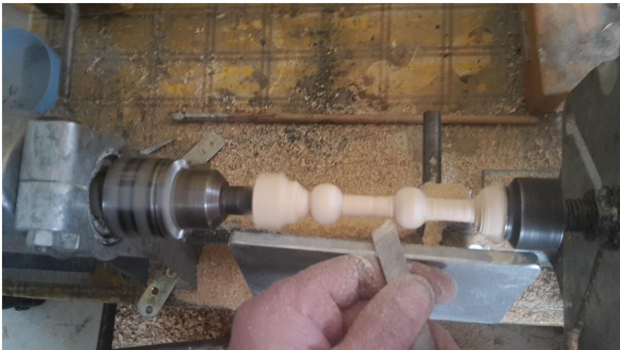
35. Sústruženie guľových prvkov do kvetov lustra
